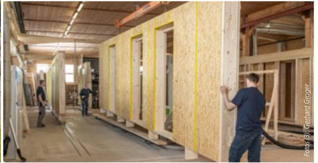
Die vorgefertigten Holzbauelemente für Wände und Decken produziert Riederbau in einem eigenen Werk. Auf der Baustelle geht es dann umso schneller
